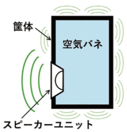
図1 スピーカーシステムの構造
