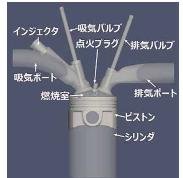
図2 エンジンの燃焼室まわりの部品
