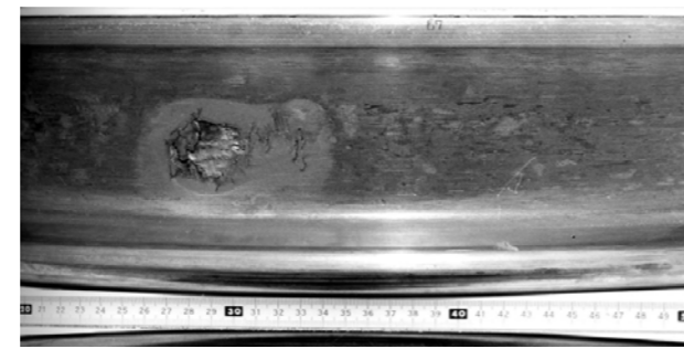
図1 車輪表面上に発生したフラット損傷
