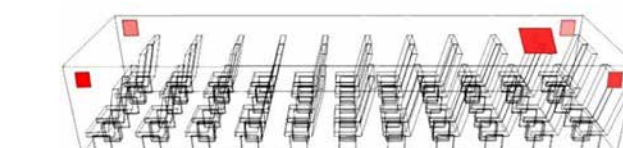
図8 後方上部にも排気口を設置
