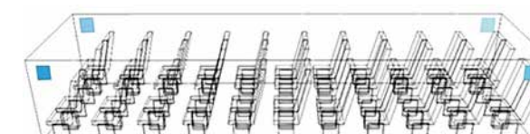
図7 従来の排気システム
