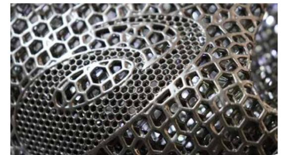
図3 ACTIBREEZE 3D SANDAL に用いた立体格子構造
