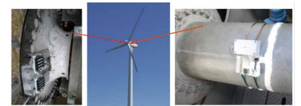
図3 風車の荷重計測
