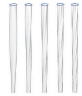
図4 ねじれ水流の形成シミュレーション
