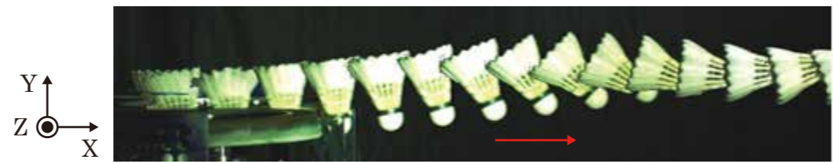
図7 最適ローラを用いたシャトルの発射の様子
