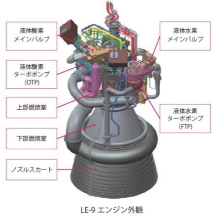
図1 新型基幹ロケットH3とその1段エンジンLE-9
