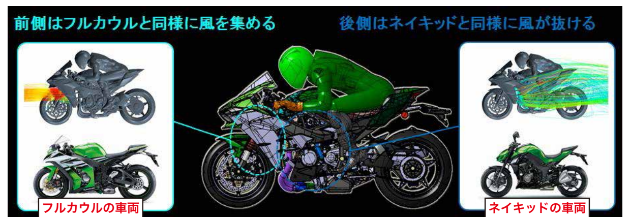
図3 冷却性能を確保するカウル形状
