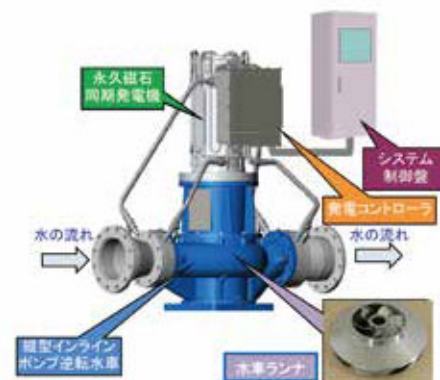
図1 マイクロ水力発電システム (22kW クラス)
