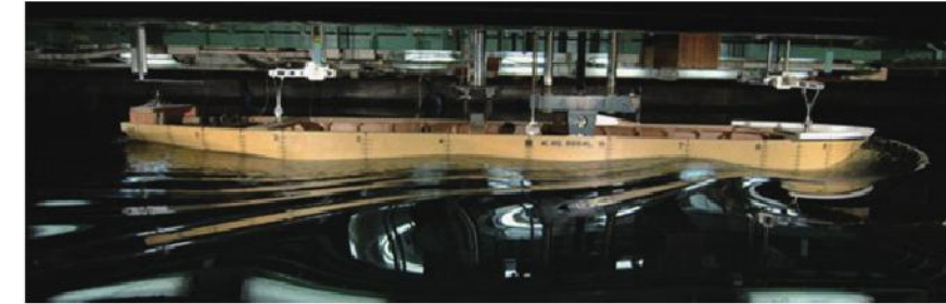
図2. 水槽試験の例 (明石船型研究所ホームページより)
