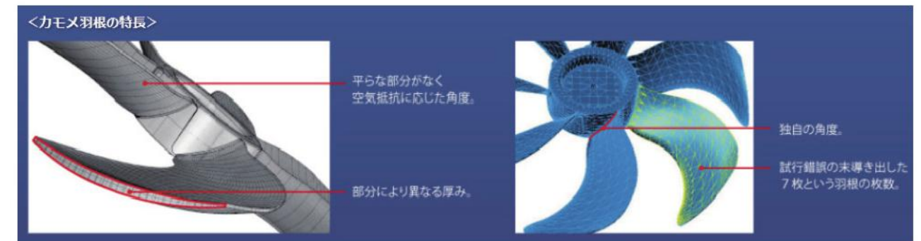
図3. カモメ羽根の解析モデル画像
