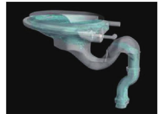
図4. 便器洗浄の排水経路の水流れ計算結果
