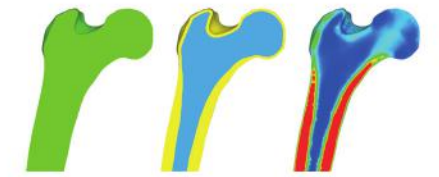
図2 左から 均質モデル 2層モデル 不均質モデル
