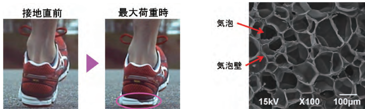
図1. ランニング中のソールの変形状態
