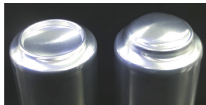
図1. 通常の缶底(左)とバックリングした缶底(右)
