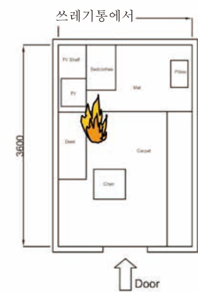
図3. 単一区画火災実験の配置図(実施場所: 湖西大学)
