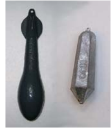
写真2. 開発した鋳鉄製オモリ(左)と従来の鉛製オモリ(右)
