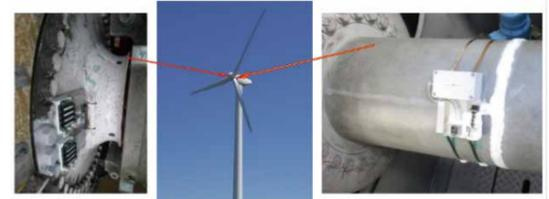
図3 風車の荷重計測
