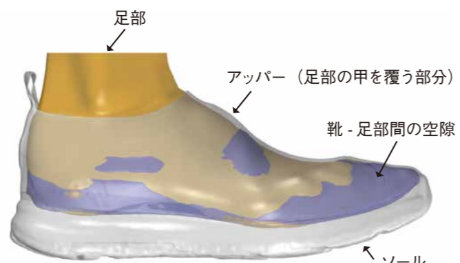
図1 靴と足部の3D CADモデル
