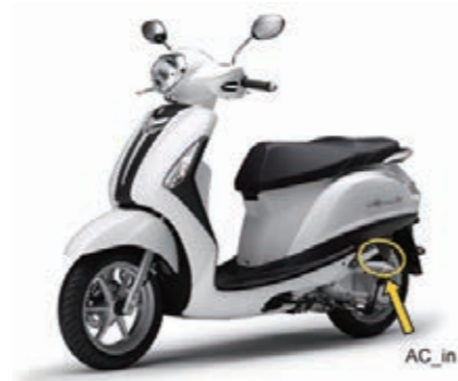
図2 評価車両とエアクリーナ吸い口 (AC_in)
