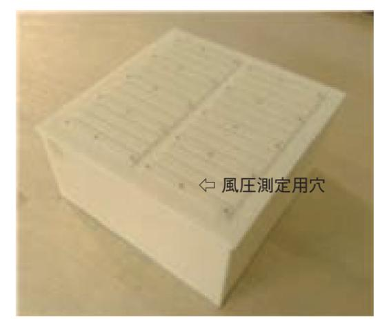
図3 風洞実験用模型
