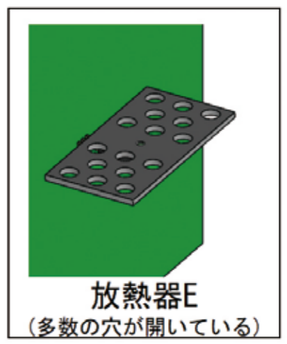
図3 新しい放熱器形状(例)
