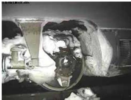
図1 着雪した鉄道車両の台車部
