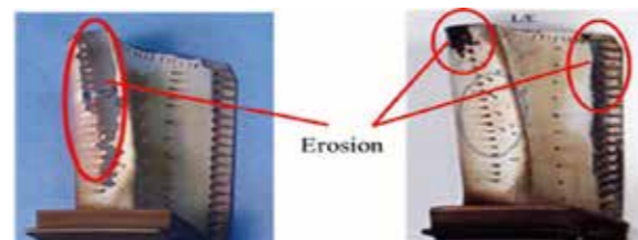
図2 タービン翼表面コーティングのエロージョンによる損傷例 [2]
