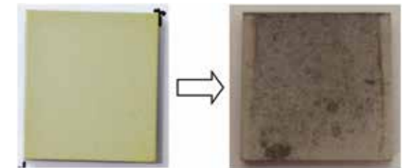
図4 エロージョン試験片 [3] (左: 試験前 右: 試験後)
