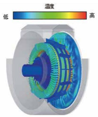
図6 発電機大規模熱流体解析の結果
