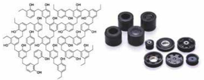
図1 フェノール樹脂の化学構造(左)と樹脂成形品(右)
