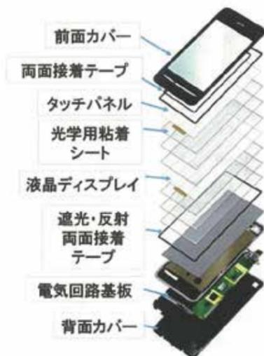
図1 スマートフォン構造の一例
