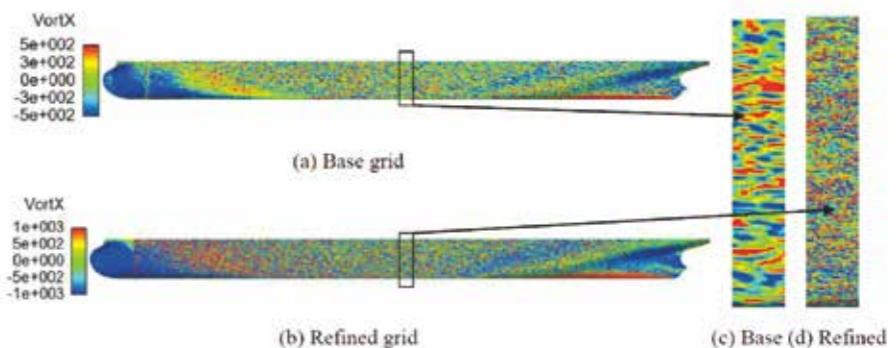
図3 船体表面渦度分布 ((a,c) 6千万格子、(b,d) 320億格子)
