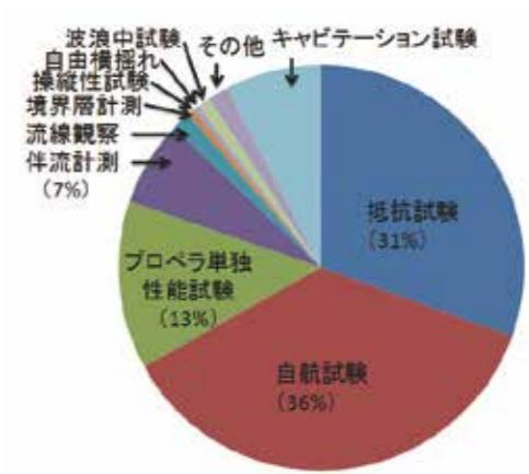
図2 日本造船技術センターの最近の試験実施実績
