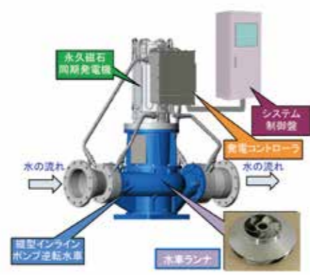
図1 マイクロ水力発電システム (22kW クラス)
