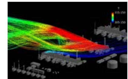
図5 計算結果(排気・吸気面からの流線)
