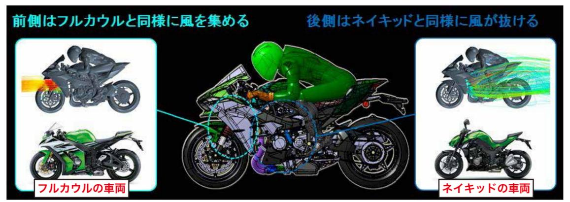
図3 冷却性能を確保するカウル形状
