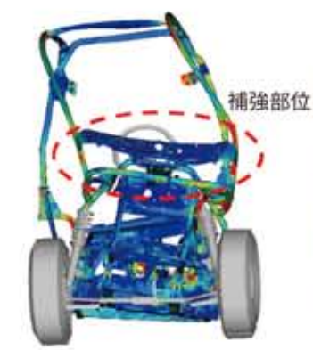
図5. 操舵初期のボディ変形(変形倍率拡大後)
