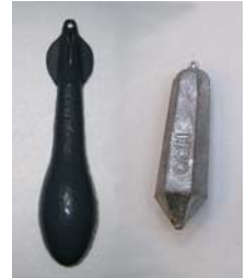
写真2. 開発した鋳鉄製オモリ(左)と従来の鉛製オモリ(右)
